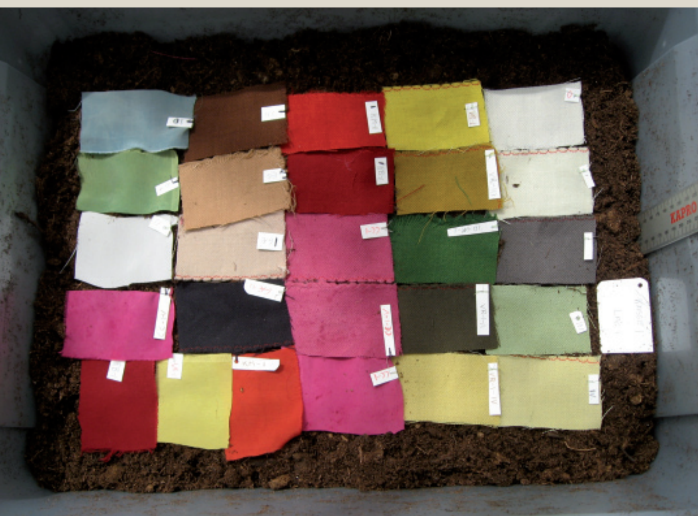
Identische Sets von Stoffproben wurden in schwach saurem Moorboden vergraben, um Textilien aus Moorfunden zu imitieren. Jedes Set wurde horizontal in einen großen Behälter auf Torf gelegt und wiederum mit einer Torfschicht abgedeckt.
