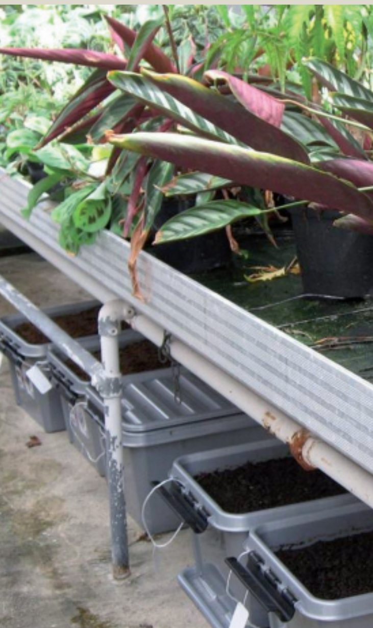
Behälter, die anoxische Verhältnisse simulierten, lagen mit einem Deckel verschlossen in wasserdurchlässigem Torfboden, um eine sauerstofffreie Atmosphäre zu garantieren. Andere Boxen ohne Deckel imitierten niedrige Sauerstoffwerte und wurden monatlich gewässert. Die Behälter wurden unter stabilen Temperaturen und Feuchtigkeitsverhältnissen in einem Gewächshaus untergebracht, da die leicht erhöhte Temperatur den Prozess beschleunigte.
