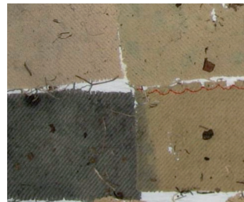
Das Kupfer-Beizmittel wanderte zu daneben liegenden Stoffproben. Da die mit Kupfer gebeizte Stoffprobe sich aufgrund der anoxischen Verhältnisse dunkel verfärbte, war das gewanderte Kupfer deutlich als dunkle Flecken auf der daneben liegenden Stoffprobe sichtbar.
