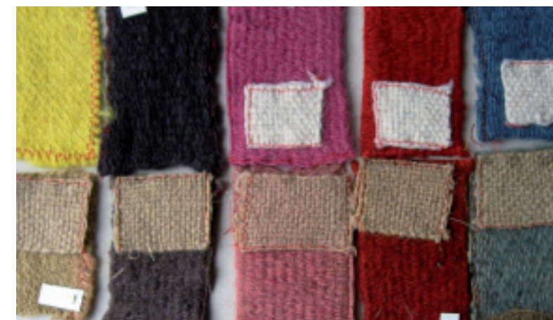
Auf einigen der gefärbten Stoffproben waren kleine Stücke ungefärbter naturweißer Wolle aufgenäht, um zu untersuchen, ob Farbe- oder Beizmittel von einem Stoff zum anderen wandern können. Die Stoffproben in der oberen Reihe waren nicht vergraben worden, von links nach rechts gefärbt mit Färberwau, Galläpfeln und Eisen, Cochenille, Krapp und Indigo. In der unteren Reihe befanden sich vergleichbare Stoffproben nach 8 Monaten Lagerung. Cochenille wurde in messbaren Spuren auf der „weißen Migrationsprobe“ gefunden, die auf die schwarze, mit Galläpfeln und Eisen gefärbte Stoffprobe genäht war. Diese Spuren waren von der pinkfarbenen Probe übertragen worden.
